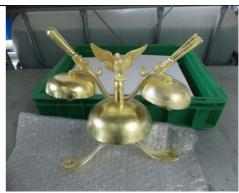
Bild plasotec GmbH Oxidschicht entfernt, hoher Glanzgrat
