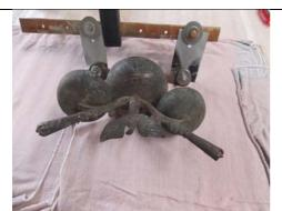
Bild plasotec GmbH starke Oxidschicht und Verunreinigungen
